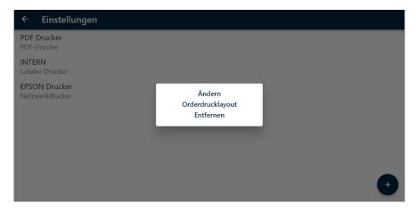
Mit der Option Ändern können je nach ausgewähltem Drucker der Name, Drucktyp, IP-Adresse und die Druckbreite eingestellt werden.
